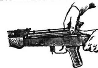
Мал. 31. Відокремлення кришки ствольної коробки
