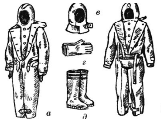
Мал. 149. Засоби захисту шкіри: а - захисний комбінезон; б- захисний костюм; в - підшоломник; з - гумові рукавиці; д - гумові чоботи
