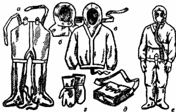
Мал. 150. Легкий захисний костюм ЛІ-1: а - штани з панчохами; б - підшоломник; в - сорочка з капюшоном; г - двопальцеві рукавиці; д - сумка для зберігання костюма; е - одягнений ЛІ-1
