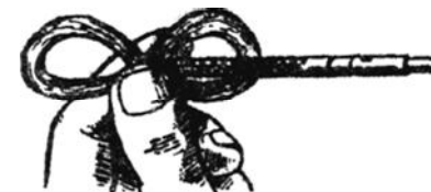
Мал. 38. Накладання клоччя на протирку
