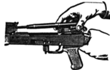
Мал. 33. Відокремлення затворної рами із затвором
