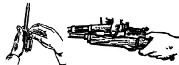
Мал. 35. Відокремлення газової трубки
